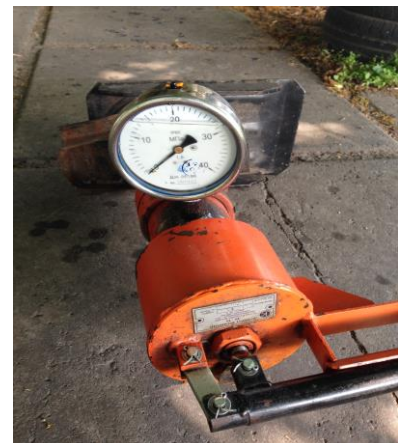
Рисунок 2 – Манометр для вимірювання горизонтального тиску, закріплений на колійному домкраті ДК-20
